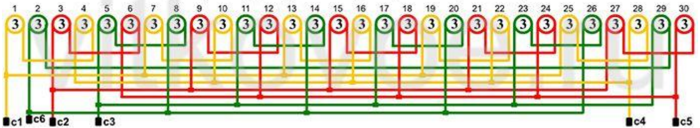
2p=10 ; Z=90 ; q=3 ; y=7 или 8 ; a=5 ; обмотка равнокатушечная
