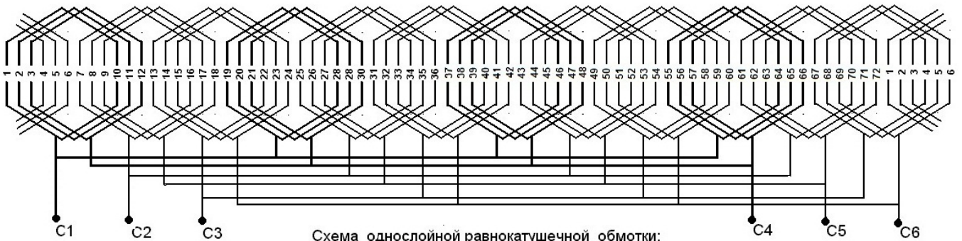
Схема однослойной равнокатушечной обмотки: 2p = 8, Z = 72, y = 1-10, a = 4
