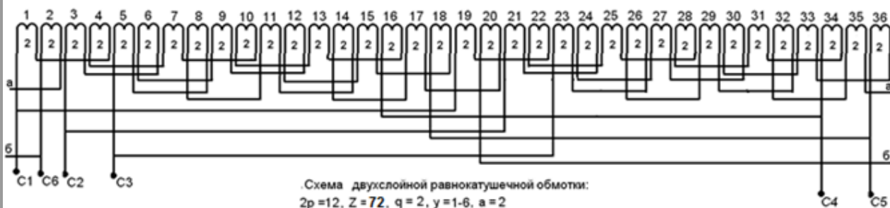
Схема двухслойной равнокатушечной обмотки: 2p = 12, Z = 72, q = 2, y = 1-6, a = 1
