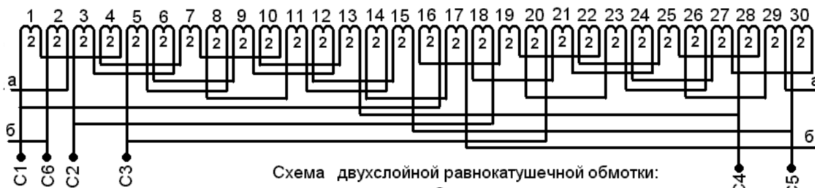
Схема двухслойной равнокатушечной обмотки: 2p = 10, Z = 60, q = 2, y = 1-6, a = 1
