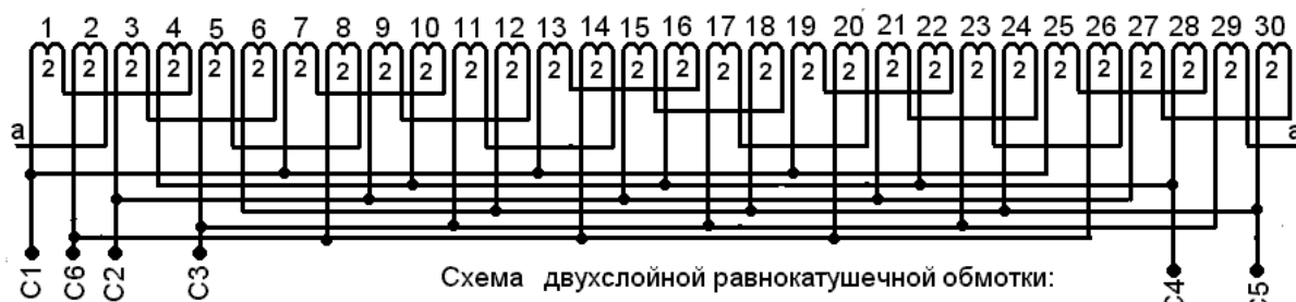
Схема двухслойной равнокатушечной обмотки: 2p = 10, Z = 60, q = 2, y = 1-6, a = 2
